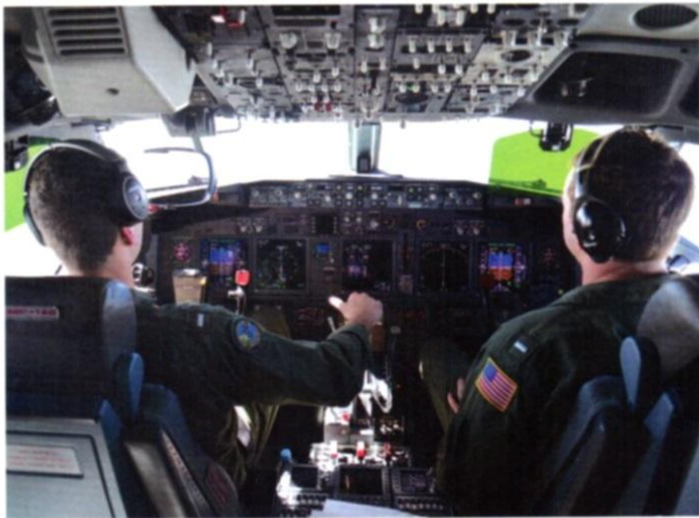
Un'immagine del cockpit di un P-8A POSEIDON, con la strumentazione digitale a disposizione del pilota e del comandante di missione. (US Navy)
