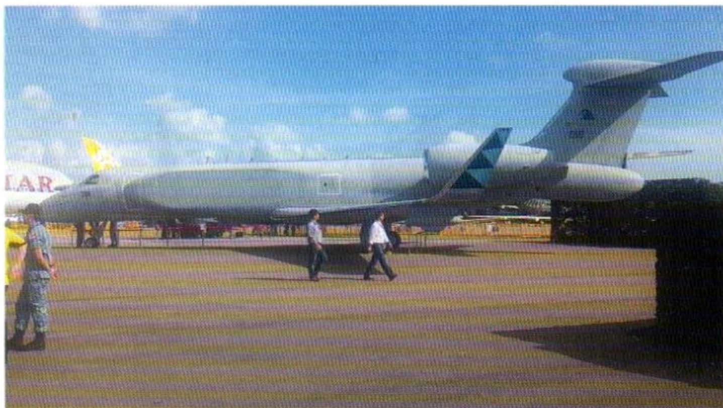
Un altro dei gioielli dell'Aeronautica di Singapore: il GULFSTREAM 550 CAEW. Si noti la carenatura speciale di fusoliera che ospita una parte delle antenne del sistema radar dual band dell'israeliana IAI/Elta.
