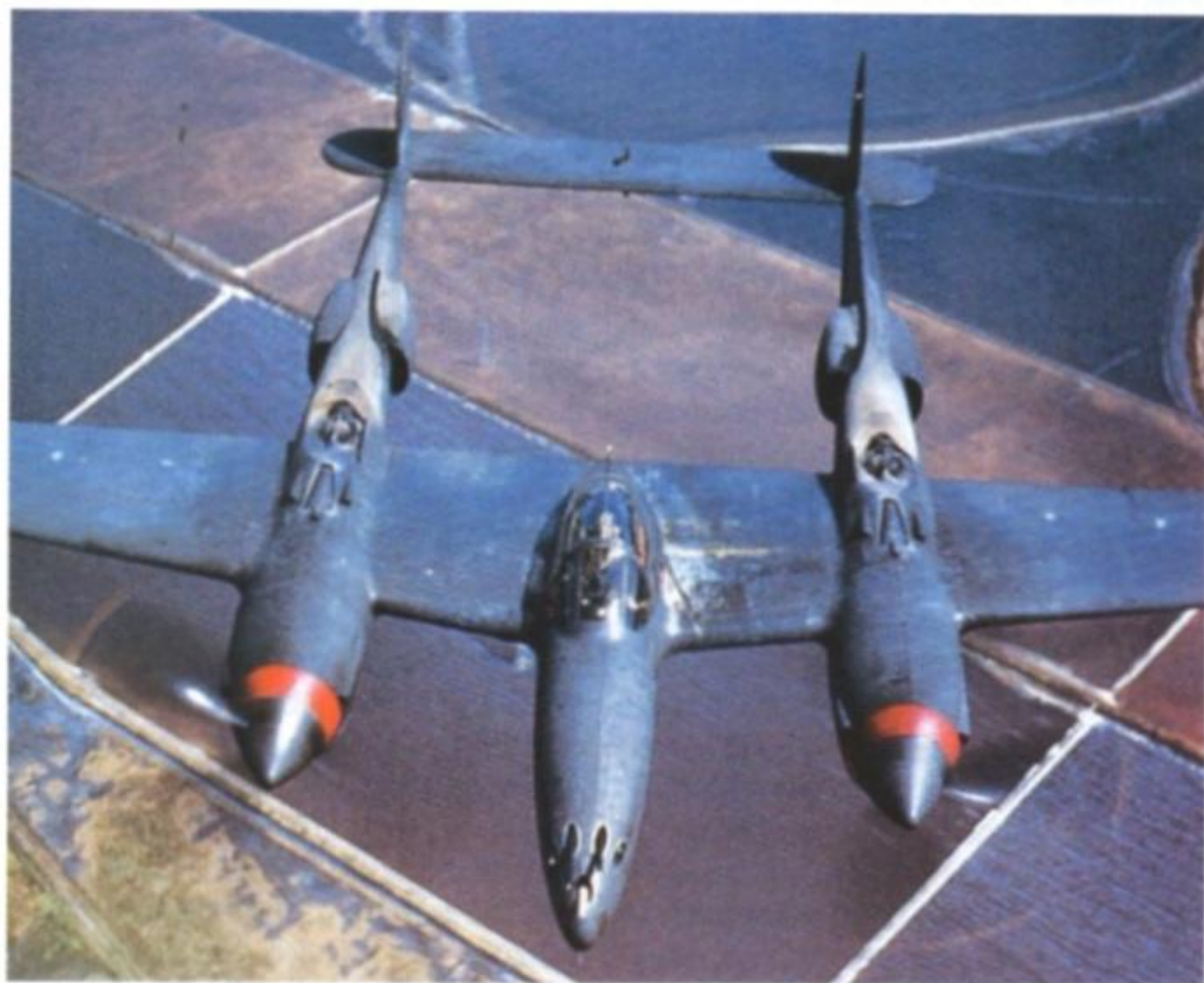
Il Lockheed P-38 LIGHTNING (nella foto un P-38E) fu il primo aeroplano ad impiegare l'Allison V-1710. Fu anche l'unico ad essere dotato del V-1710 turbocompressi.
