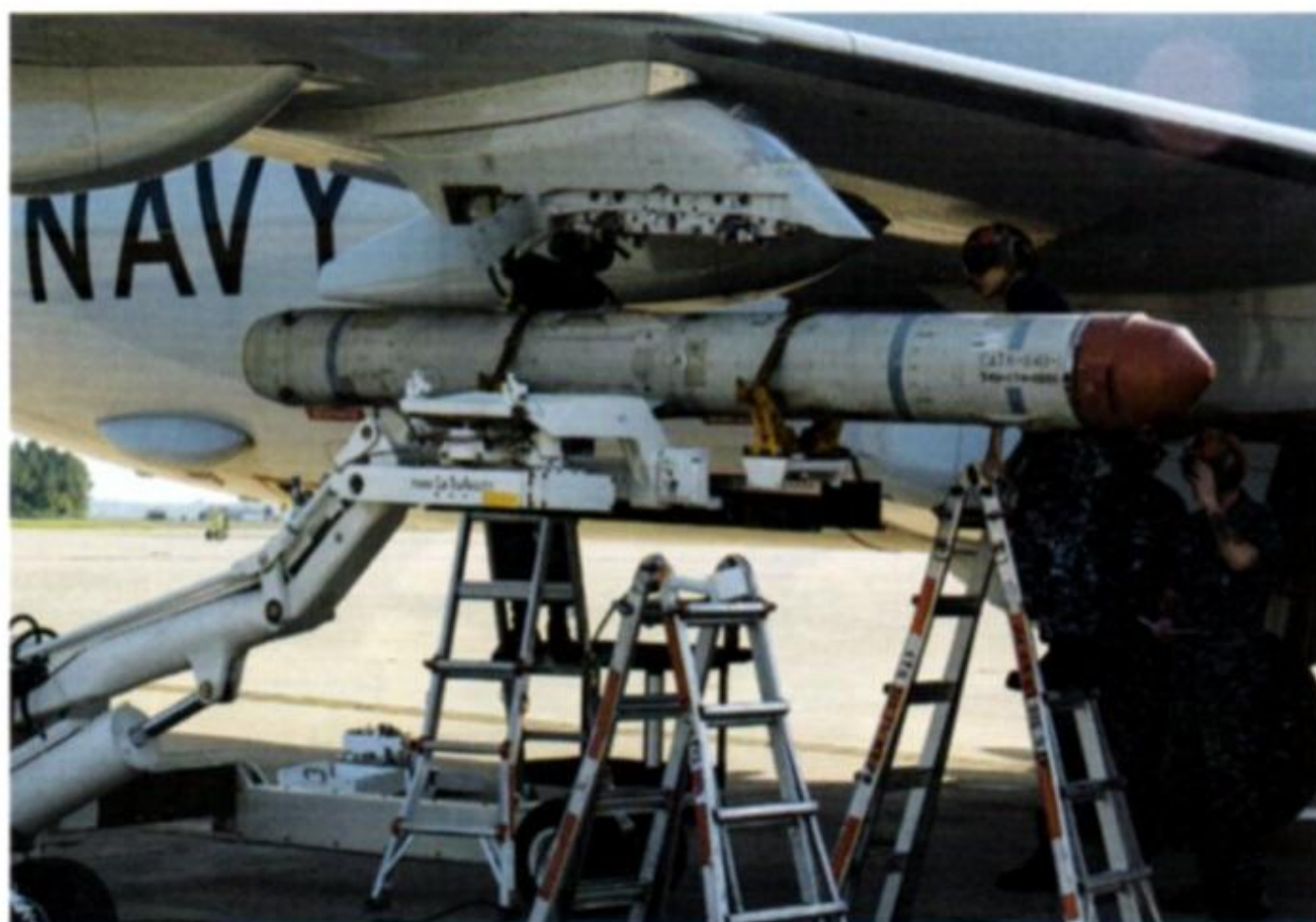
Aprile 2015: il montaggio di un missile aria-superficie AGM-84K SLAM-ER (Stand-off Land Attack Missile Expanded Response) su uno dei piloni subalari di un POSEIDON di base a Jacksonville. La disponibilità di quest'ordigno permetterà di espandere notevolmente lo spettro di missioni del P-8A, compreso l'attacco contro obiettivi terrestri situati in zone non distanti dalle coste avversarie. (foto: USN)
