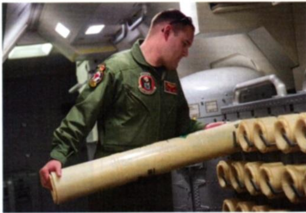
A sinistra: il P-8A è dotato di un'avanzata torretta elettro ottica MX-20HD della Wescam-L3. A destra: un tecnico scarica una sonoboa dalla rastrelliera. Il P-8A può trasportare fino a 126 sonoboe di vario tipo in diversi tipi di lanciatori. (foto: USN)
