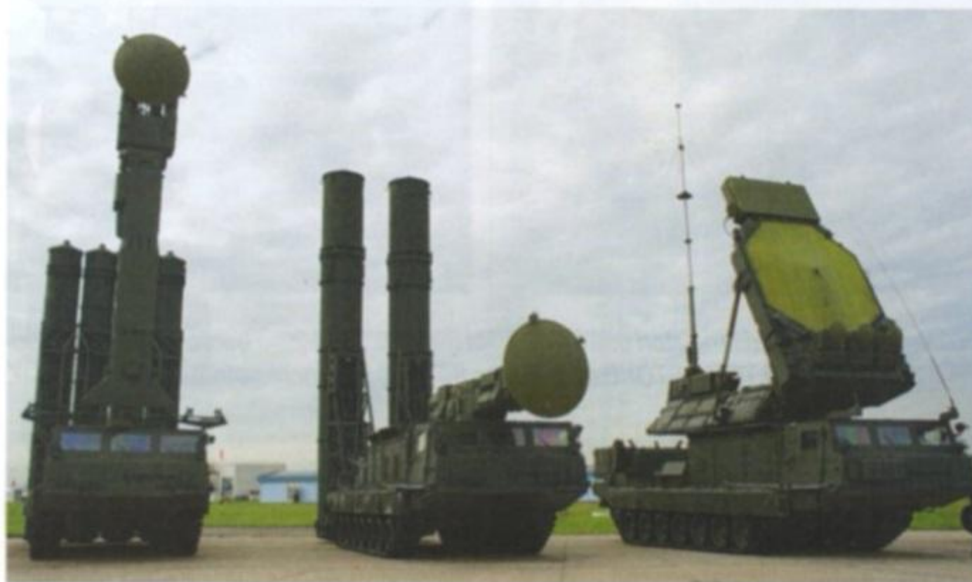
Sopra: altri 2 componenti del sistema S-500. Il Posto Comando 55K6MA (a sinistra) e il radar di ingaggio multimode 76T6 (a destra). Sotto: 3 dei componenti del sistema S-300 V. A sinistra le 2 unità di fuoco (TELAR 9A83 il primo, 9A82 il secondo), a destra il radar di tracking/guidamissili 9S32 GRILL PAN.
