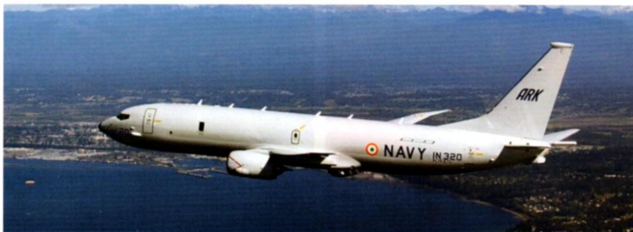
Il primo volo del P-8I NEPTUNE, versione del POSEIDON adattata alle esigenze dell'India. Diversamente dai velivoli statunitensi il NEPTUNE è dotato del rivelatore di anomalie magnetiche (MAD) in coda. (foto: Boeing)
