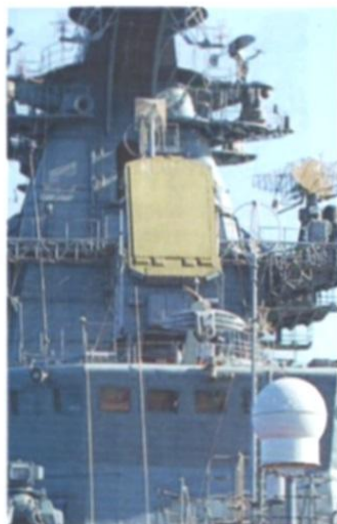
A sinistra: contenitori/lanciatori dell'S-300 F/FM (SA-N-6/SA-N-20) a bordo di un incrociatore. A destra: il radar TOMB STONE del sistema SA-N-20 sull'incrociatore PYOTR VELIKIY.
