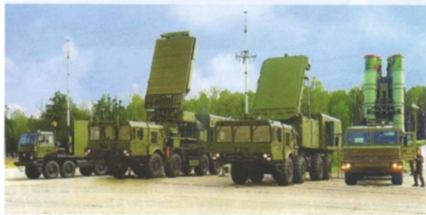
I principali componenti del sistema missilistico sup/aria S-300 PMU-3 (S-400 TRIUMF), SA-21 GLOWLER per la NATO (manca solo il radar a grande portata 91N6E).
