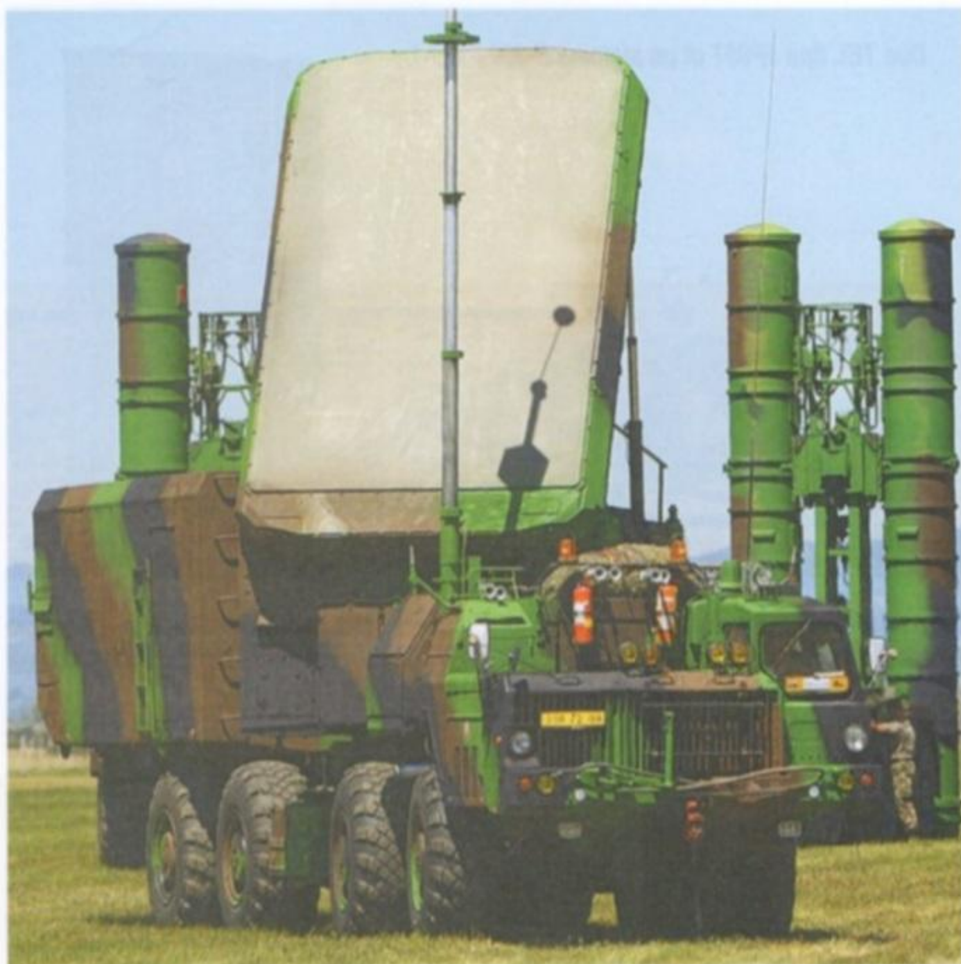
Sopra: alcuni componenti di un sistema S-300 PMU-1 dell'Esercito Slovacco con in primo piano il veicolo con radar di acquisizione/guidamissili FLAP LID. Sotto: radar CLAM SHELL e FLAP LID su mast 40V6M da 23,8 m.
