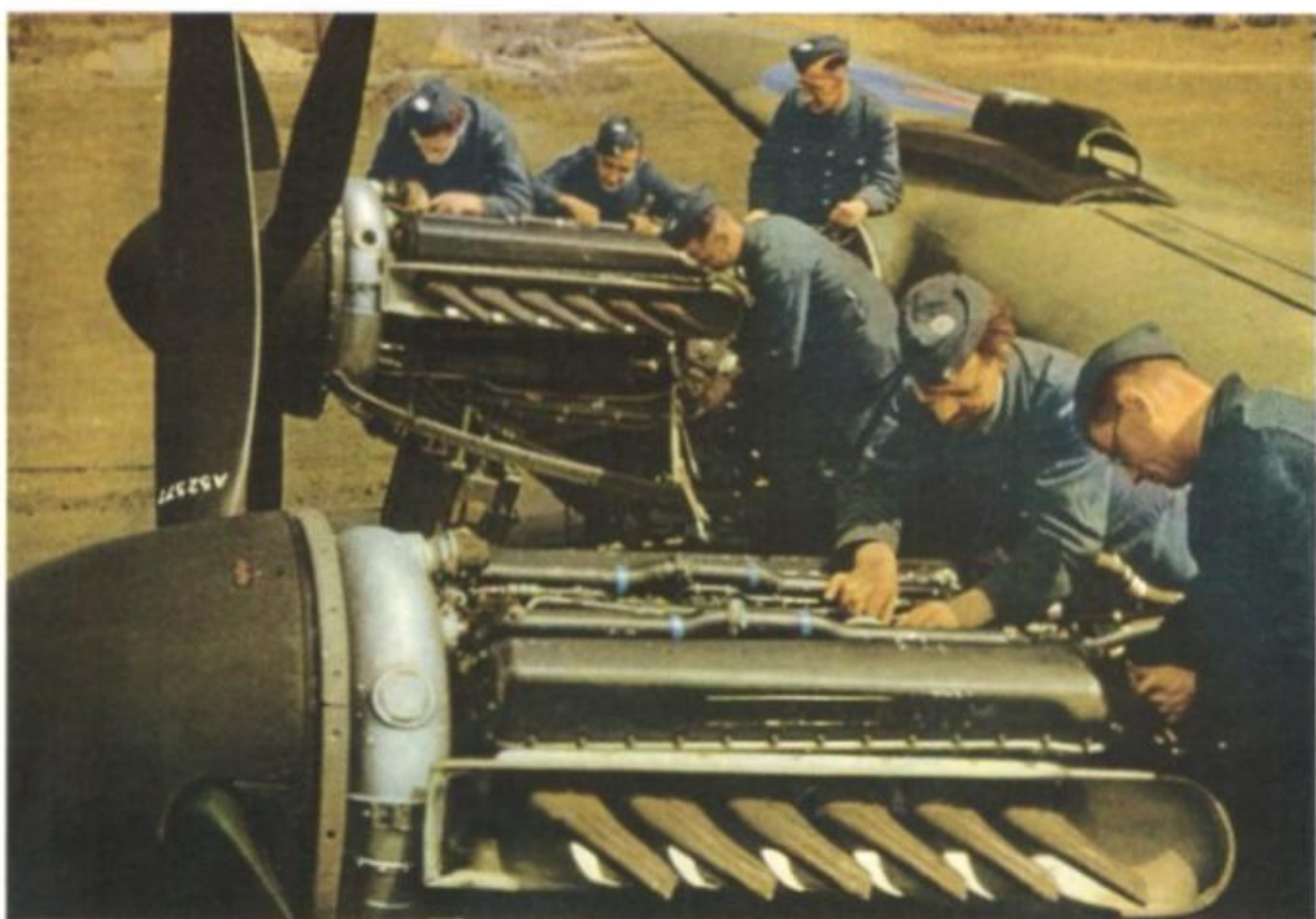
Meccanici della RAF al lavoro sui motori MERLIN 28 di un LANCASTER Mk-III. Il possente bombardiere fu tra gli aeroplani più importanti del conflitto per il determinante contributo che diede all'offensiva contro le città e le infrastrutture produttive tedesche.
