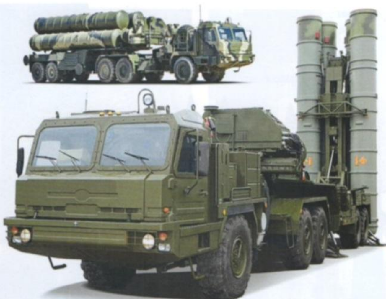
Sopra: il TEL degli esemplari più recenti dell'S-300 PMU-2 FAVORIT e del PMU-3 TRIUMF (S-400) impiegano il nuovo autocarro BAZ-6402. Sotto: il complesso radar BIG BIRD visto di 3/4 dietro.
