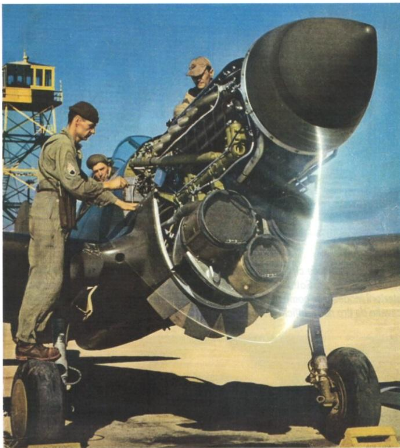
Prova motore per un P-40D, la prima versione del caccia che impiegò il V-1710 serie F con riduttore avente l'albero portaelica disassato rispetto all'albero motore. Evidenti i 3 radiatori (quello dell'olio è al centro) e la facile accessibilità alla meccanica.
