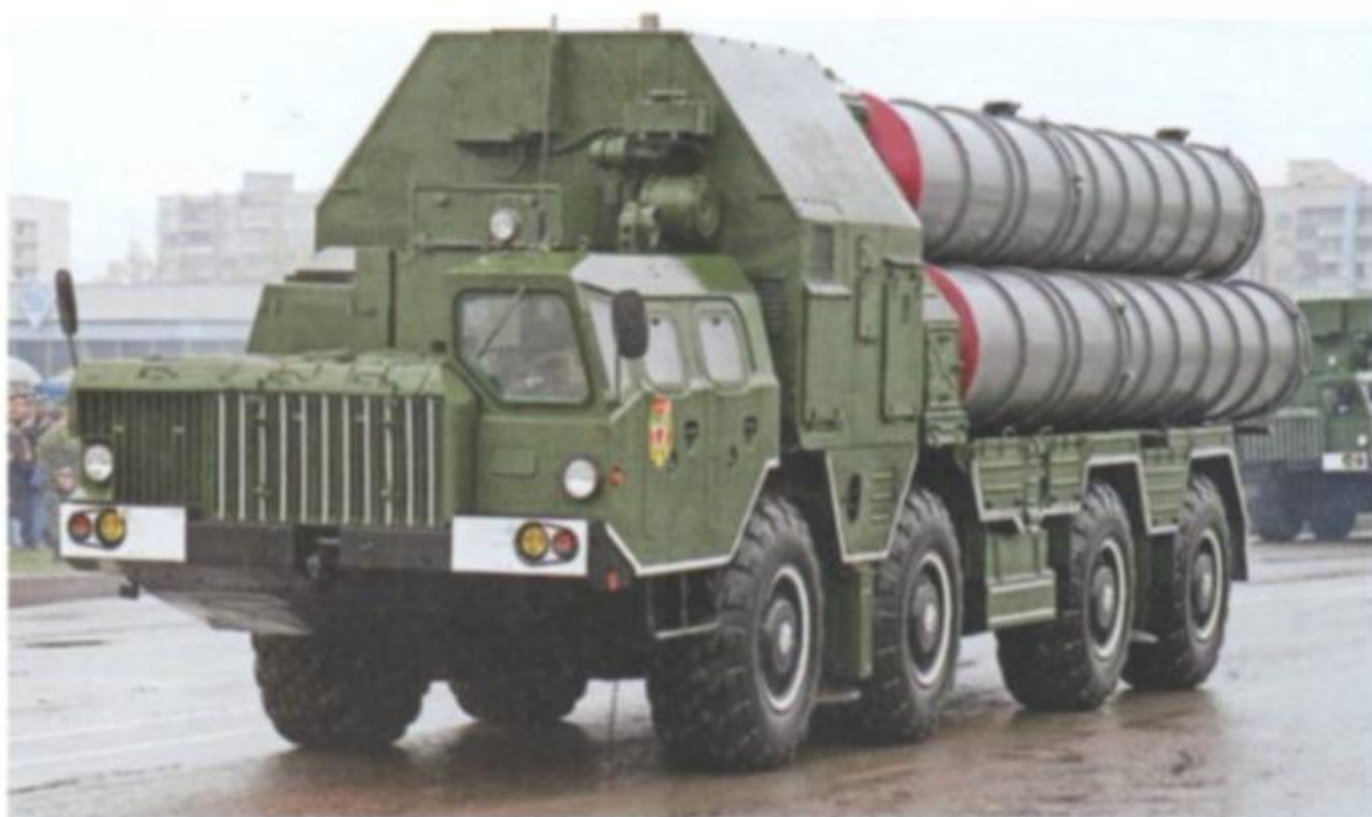
L'S-300 P ha impiegato il TEL 8x8 MAZ-7910 nelle versioni PS, PM-1 e inizialmente anche nella PMU-2 FAVORIT.
