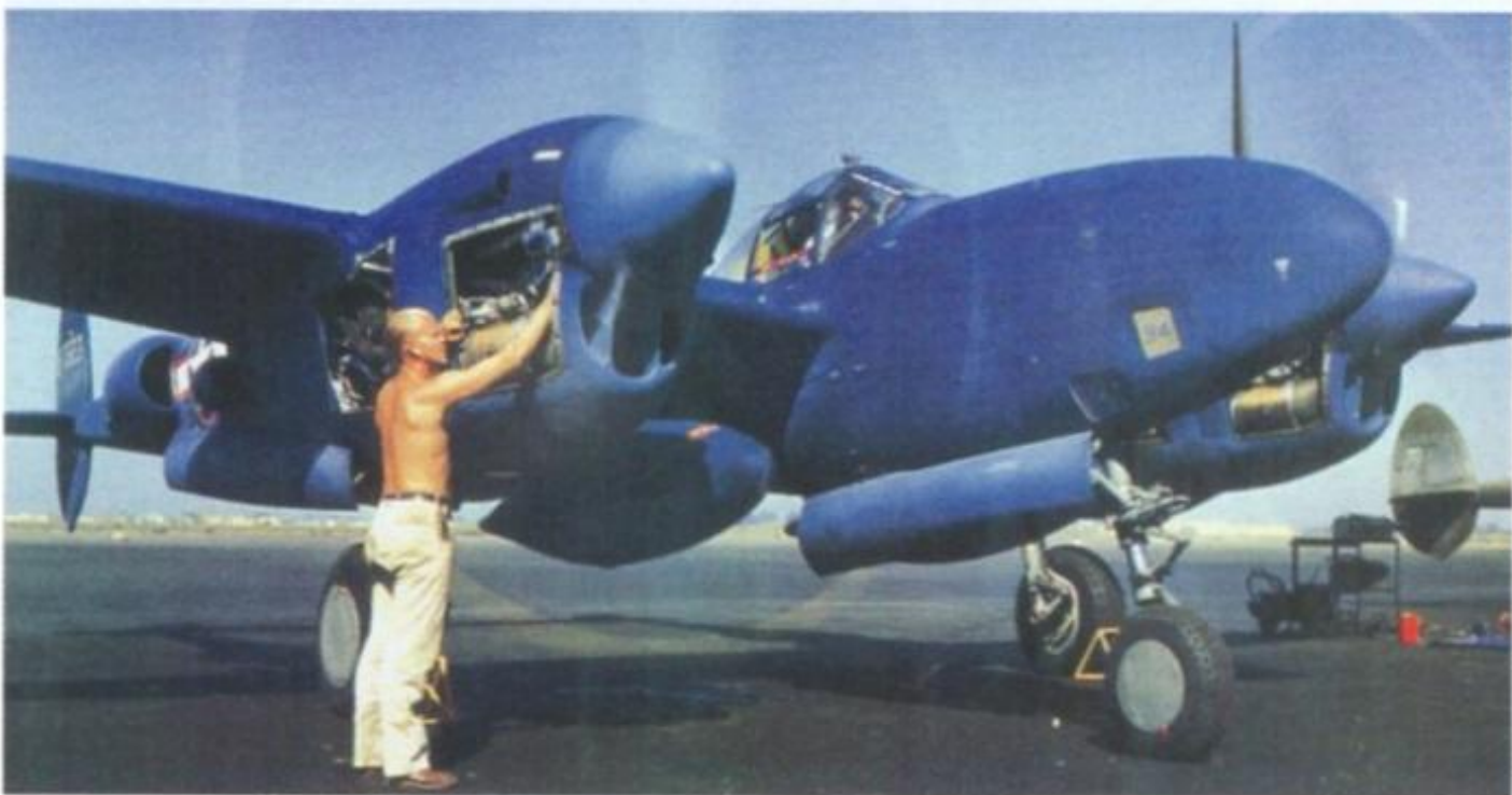
Un F-5, la velocissima variante da ricognizione del P-38. Ricavata per conversione dei P-38 mediante lo smontaggio dell'armamento, ospitava le fotocamere nel muso (notare le finestrelle).
